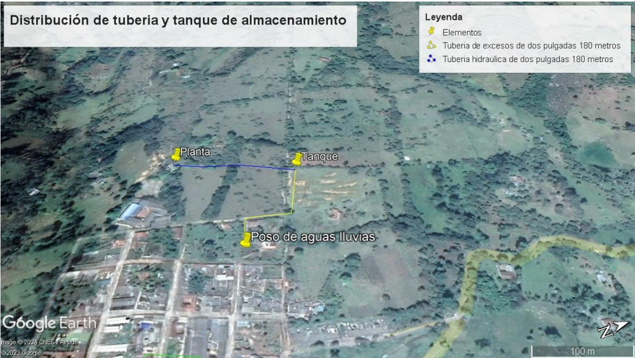
Ilustración 6:Distribución de red y tanque de almacenamiento.
